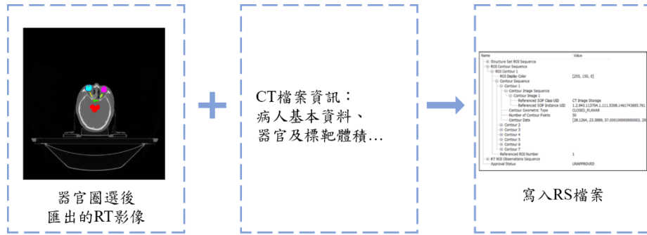
圖7、將RT影像的資訊寫入新的RS檔之流程圖
